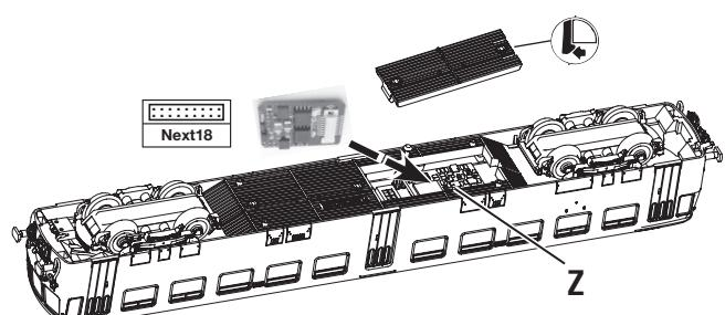
**Einbau eines digitalen Empfängerbausteins in den Steuerwagen:**
